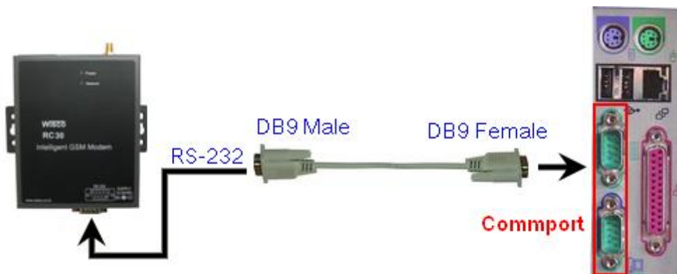
การเชื่อมต่อ RC30 กับเครื่องคอมพิวเตอร์ผ่านทาง Serial Port
