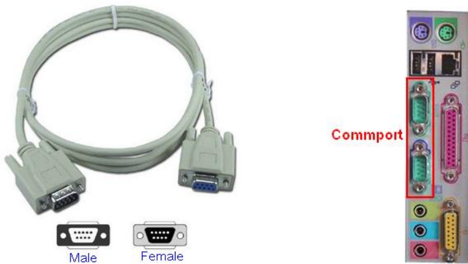
สาย DB9 และ Commport ของเครื่องคอมพิวเตอร์
